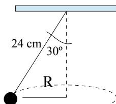
5. En la figura se representa un péndulo cónico. La masa vale dos kilogramos; la cuerda tiene una longitud de 24 cm. La masa se mueve con un m.c.u., describiendo circunferencias horizontales. Si la cuerda forma un ángulo de 30° con la vertical, halla el periodo del péndulo
