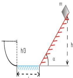
10. La pista de la figura está formada por un tramo inclinado un ángulo  $\alpha = 30^\circ$ , un tramo horizontal de longitud  $d = 0.2 \text{ m}$  y un cuadrante circular de radio  $R = h/3$ . Una masa considerada puntual  $m = 3 \text{ kg}$  se sitúa sin velocidad inicial a una altura  $h = 2 \text{ m}$  sobre el plano inclinado y cae por la pista. Entre la masa y los dos tramos rectilíneos hay rozamiento con coeficiente  $\mu = 0.2$  y en el tramo curvo no hay rozamiento.
