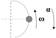
7. Una rueda de 50 cm de diámetro gira a una velocidad angular de 100 rad/s cuando se le aplica un freno que le comunica una aceleración tangencial de frenado  $|\vec{a}_t| = 6 \text{ m/s}^2$ . ¿Cuántas vueltas da hasta que se para?
