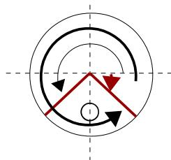
La calculadora da como solución un ángulo de  $-0'524$  rad. (el ángulo pequeño y negativo). Pero ese valor no nos vale, ya que en el m.a.s. se toma siempre sentido positivo. Las dos soluciones válidas en esta primera vuelta serían  $(\pi+0'524)$  y  $(2\pi-0'524)$ , que son los dos ángulos positivos dibujados. Sustituyendo cada uno de estos valores tendremos:
